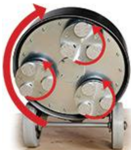
Figur 41 Illustrerar sliphuvudernas rotation i förhållande till växelhuset.
