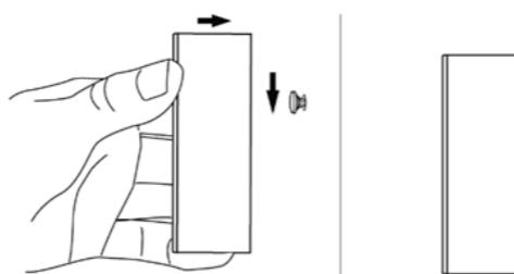
Häkävaroitin aktivoidaan automaattisesti seinä- tai kattoasennuksen yhteydessä – muussa tapauksessa se aktivoidaan manuaalisesti mukana tulevan asennusruuvin avulla, jota liikutetaan ylöspäin kiinnitysreiässä.
