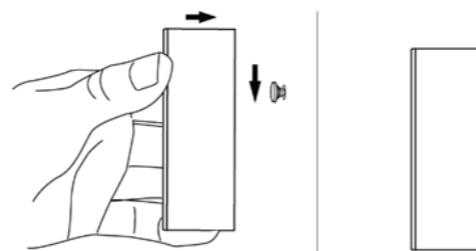
CO-varnaren aktiveras när den monteras på vägg eller tak, vid fristående användning aktiveras den manuellt med den medföljande monteringskruven som då förs uppåt i fästhålet.
