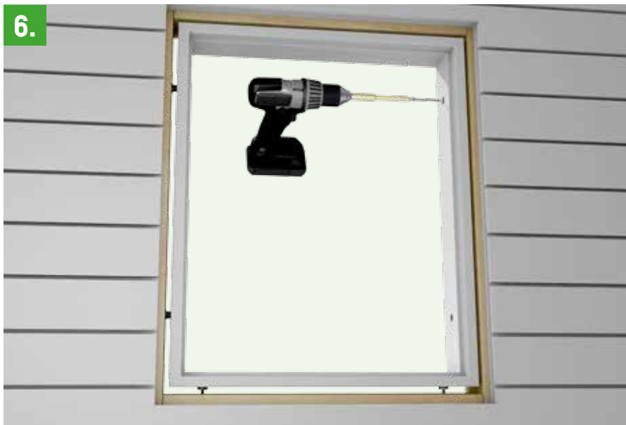
6. Betong och tegel måste förborras med 6 mm borrh. Borrhningen sker genom hylsan in i väggen.
