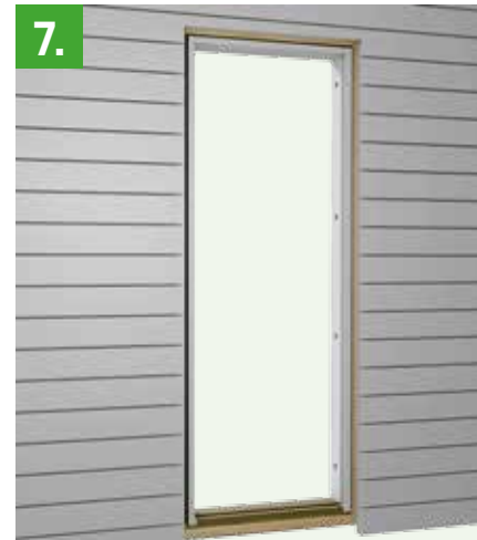
7. Skruva nu ut de resterande hylsorna (om det finns) och skruva in skruv genom hylsorna in i väggen.
